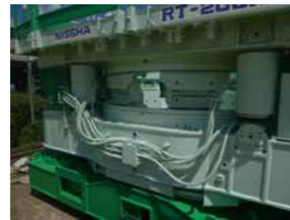
▲RT-200H外廻し配管(内側)
